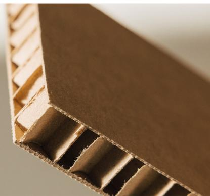
**Cartón estructural** con dos coberturas de papel exterior de **alto gramaje** y una estructura interior en forma de celdas **hexagonales**.
